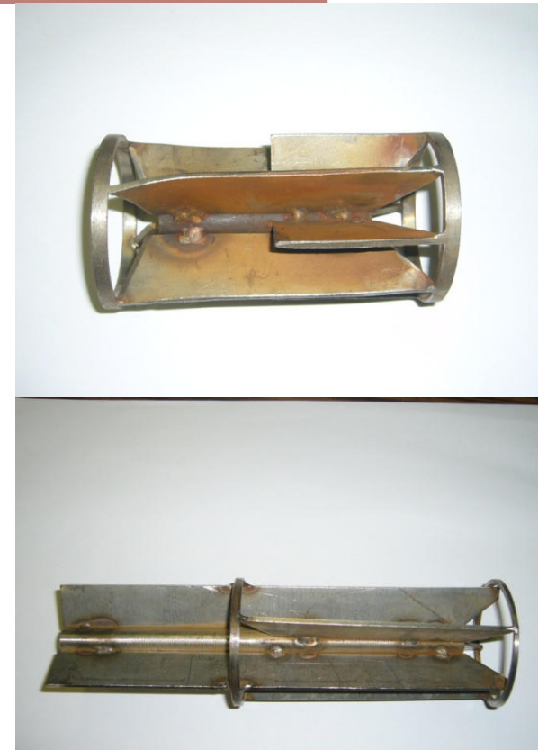
Схема вихревой трубы теплогенератора
